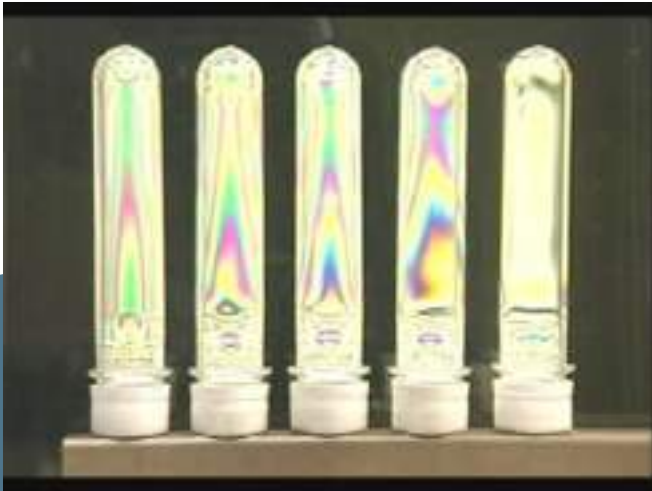
Estado de orientaciones y tensiones residuales de la preforma
